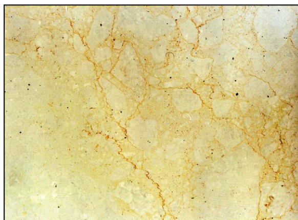
Figure 144 - Section polie d'un « sucre » et lame mince en LN (x 4) de la brèche marmoréenne inorganisée affectée de stylolites de l'affleurement précédent (Fig. 143).
