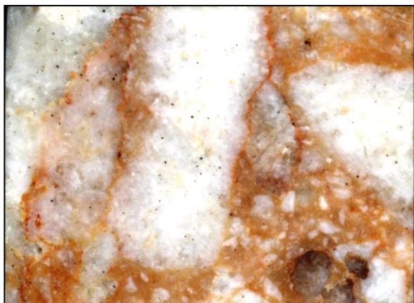
Figure 144 - Section polie d'un « sucre » et lame mince en LN (x 4) de la brèche marmoréenne inorganisée affectée de stylolites de l'affleurement précédent (Fig. 143).
