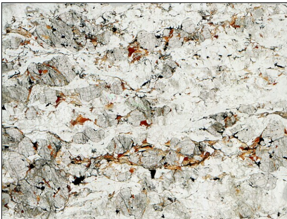
Figure 193 – Kinzigite de l'écaïlle de gneiss catazonaux du port de Lherz (Echantillon, lame mince en LN et LP, 2 x 1.5 cm). Remarquer la foliation soulignée par l'orientation des cristaux de quartz, feldspath et biotite et la répartition des grenats, la sillimanite n'est pas visible.
