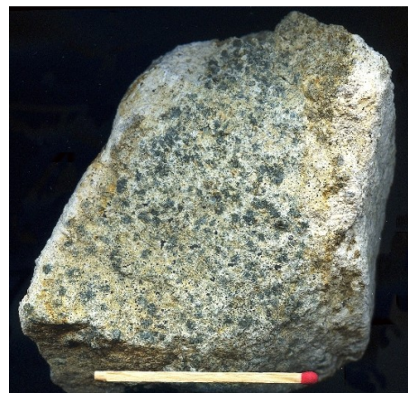
Figure 83 - Ophite altérée montrant son aspect typique en « peau de serpent » (Aucazein). Remarquer à D et à G le remplissage très clair, essentiellement constituée de scapolite, des cassures qui l'affectent.
