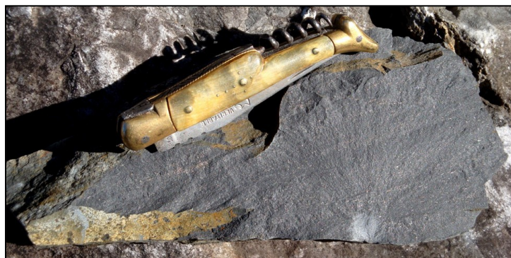
Figure 114 - Linéation soulignée par l'alignement des fins cristaux de pyrite dans le marbre noir
