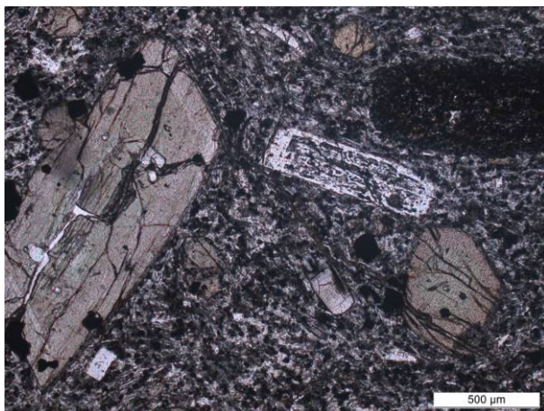
Fig. 212 - Microphotographies 6C71c - LM C59234 : détail de phénocristaux de clinopyroxène, d'amphibole opacifiée et de plagioclase, dans une mésostase microlitique. Microphotos PC 2014 en lumière polarisée, non analysée à gauche, analysée à droite.
