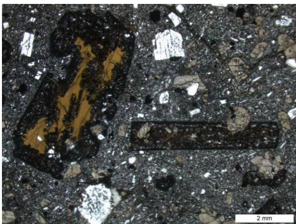
Fig. 224 - Microphotographies 5A06b- LM C57455 : phénocristaux de kaersutite en partie opacifiée, de clinopyroxène et de plagioclase, dans une mésostase microlitique.
