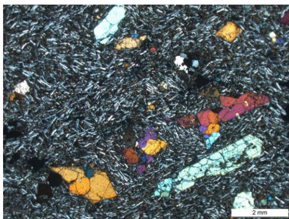
Fig. 179 - Microphotographies 8C02a - LM C59237 : phénocristaux d'olivine et xénocristal de quartz (Q) dans une mésostase à texture doléritique divergente.
