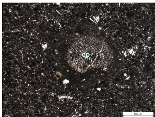
Fig. 276 - Microphotographies 5C69b-LM C59227 : amas de microcristaux de clinopyroxène (cp), dans une mésostase microlitique.
