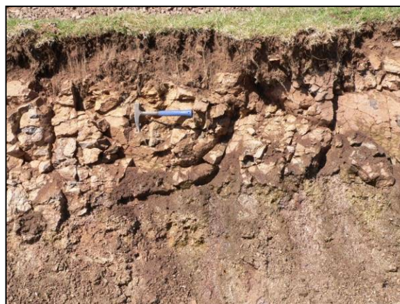
Fig. 160 - Au NNW du point coté z=995 m basalte s.l. fracturé et plus ou moins altéré, sous 20 cm de sol brun photo PC 1D17 23/03/2011.
