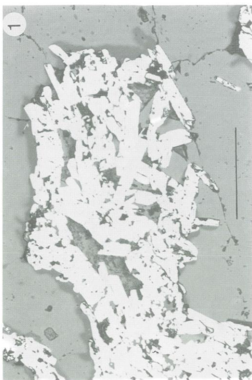
Fig. 3. — Détail de la zonation d'un prisme lancéolé; image en électrons secondaires à la microsonde électronique (CAMEBAX); noter l'alternance de bandes claires et sombres, reflétant des teneurs variables en niobium, et soulignant les zones de croissance, au cœur du cristal; on observe une forte corrosion, qui débute toujours dans les bandes sombres. Échantillon ECH 45-2, stockwerk de la Bosse; la barre représente 40 micromètres.
