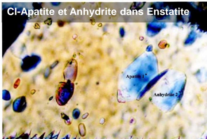
Plage d'inclusions dans l'enstatite : inclusions simples et coalescentes d'anhydrite, inclusion d'apatite coalescente avec de l'anhydrite (\*voir données microsonde).
