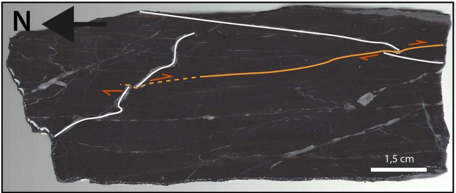
Figure 19 : Photo de veines cisailantes sur une section d'échantillon (TC1).
