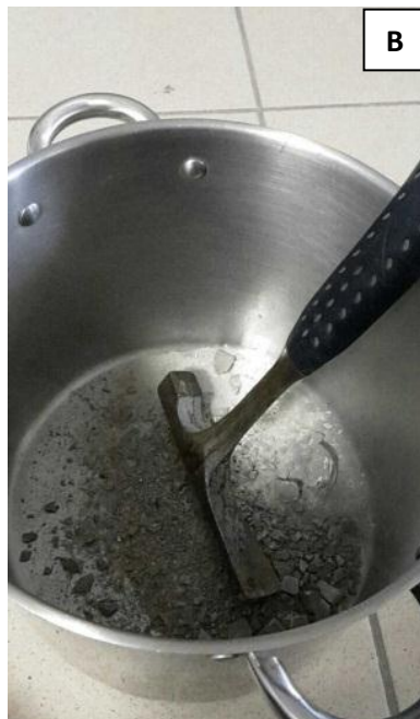
Figure 2 : A : Etape de sciage ; B : Broyage au marteau ; C : Broyage au Broyeur mécanique
