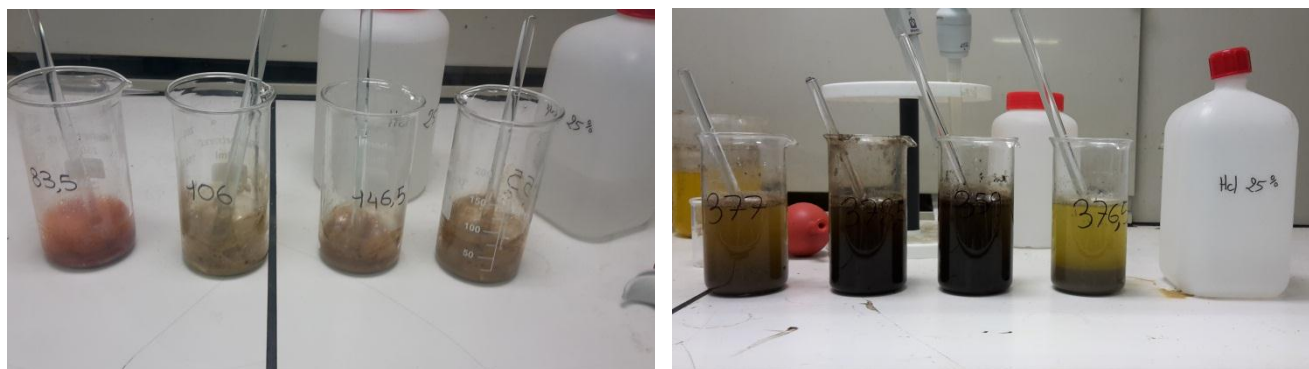
Figure 3 : Décarbonatation des échantillons
