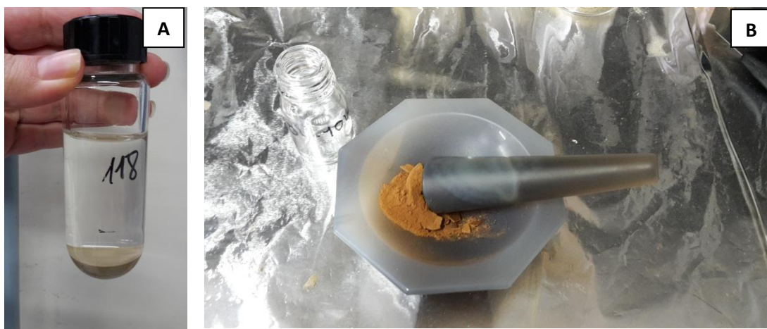
Figure 4 : A : Rinçage de l'échantillon ; B : Broyage de l'échantillon dans un bol en agate après la phase de séchage
