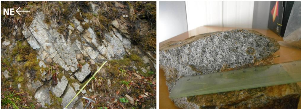
FIGURE 4.9 – Gauche : Horizon fissuré basculé (affleurement 18) dans la granodiorite proche du village de Ris [Photo Carcone, 2014], (b) Droite : Echantillon de granite à deux micas avec biotites entourées d'une auréole d'altération [Photo Carcone, 2014]
