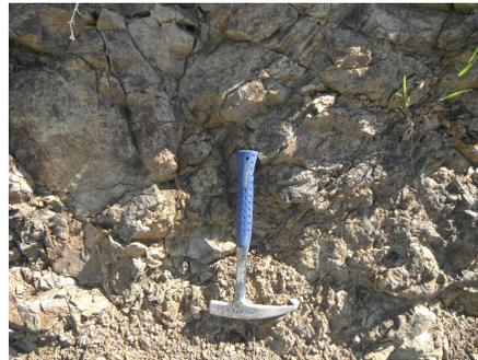
FIGURE 4.10 – Limite entre horizon fissuré et horizon feuilleté (affleurement 52) [Photo Carcone, 2014]. La roche est très altérée mais on observe encore quelques fissures basculées héritées de l'horizon fissuré
