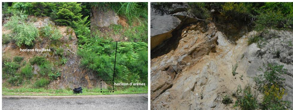
FIGURE 5.23 – (a) Gauche : Contact entre horizon d’arènes et horizon feuilleté sur le granite (affleurement 088) [Photo Carcone, 2014], (b) Droite : Horizon feuilleté (affleurement 055) intercalé dans l’horizon fissuré dans lequel on observe encore la structure de la roche, avec des fissures issues de l’altération [Photo Carcone, 2014]
