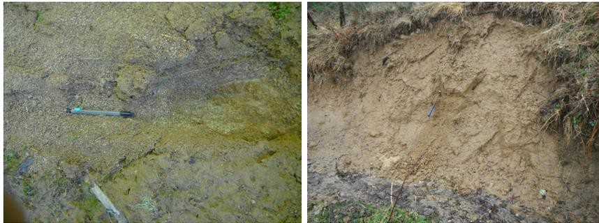
FIGURE 4.13 – (a) Gauche : Horizon d'arènes sablo-argileuses (affleurement 41) présentant de la matière organique [Photo Carcone, 2014], (b) Droite : Horizon d'arènes très argileuses (affleurement 9) indiquant le sommet du profil d'altération [Photo Carcone, 2014]
