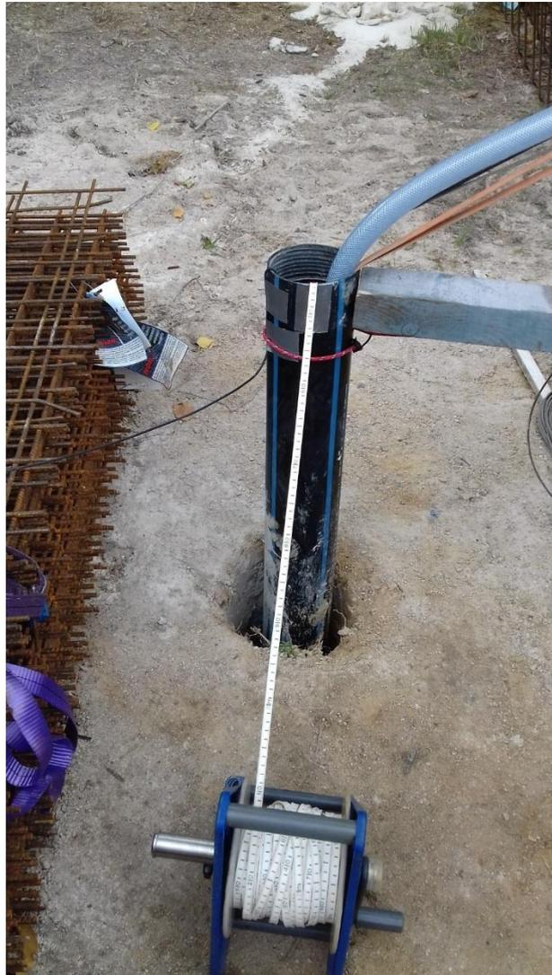
*Illustration 5 – Sonde piézométrique utilisée pour suivre le niveau dynamique dans le puits de pompage*
