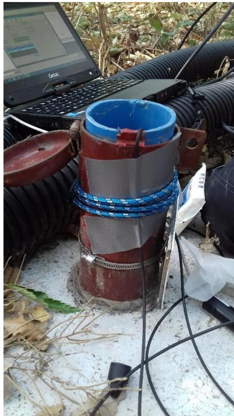
*Illustration 3 – Piézomètre dans lequel est installé un capteur de pression Diver suspendu par un câble connecté, ce capteur est interrogeable en temps réel*
