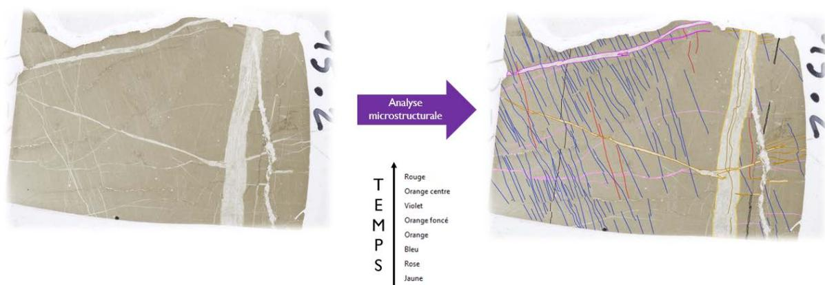
Figure 8 : lame mince de l'échantillon 15-2 (Gauche) et analyse microstructurale (Droite).
