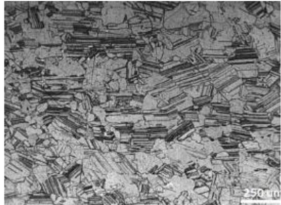
**Figure 10 : Micro-texture de la sphalérite recristallisée, désordonnée et maclée dans le massif de Cinco Villas (zone de Vera, Espagne) (LRA attaquée au NaClO, Pesquera & Velasco)**
