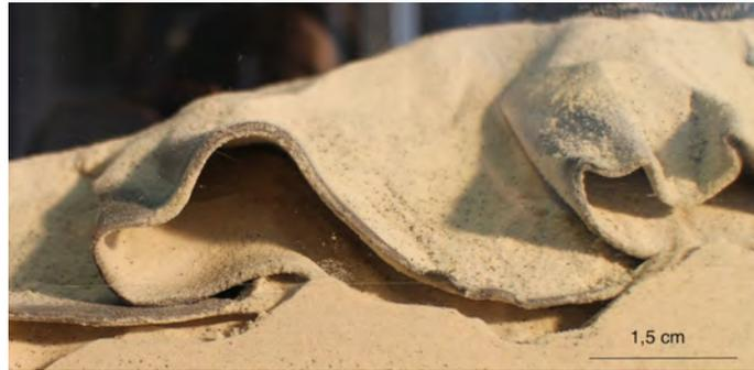
FIGURE 12 – Photographie de la couche de plasticine dégagée du sable après l'expérience. Cette couche est effectivement plissée mais ne semble pas amincie et n'est pas traversée par les chevauchements en base de charnière.
