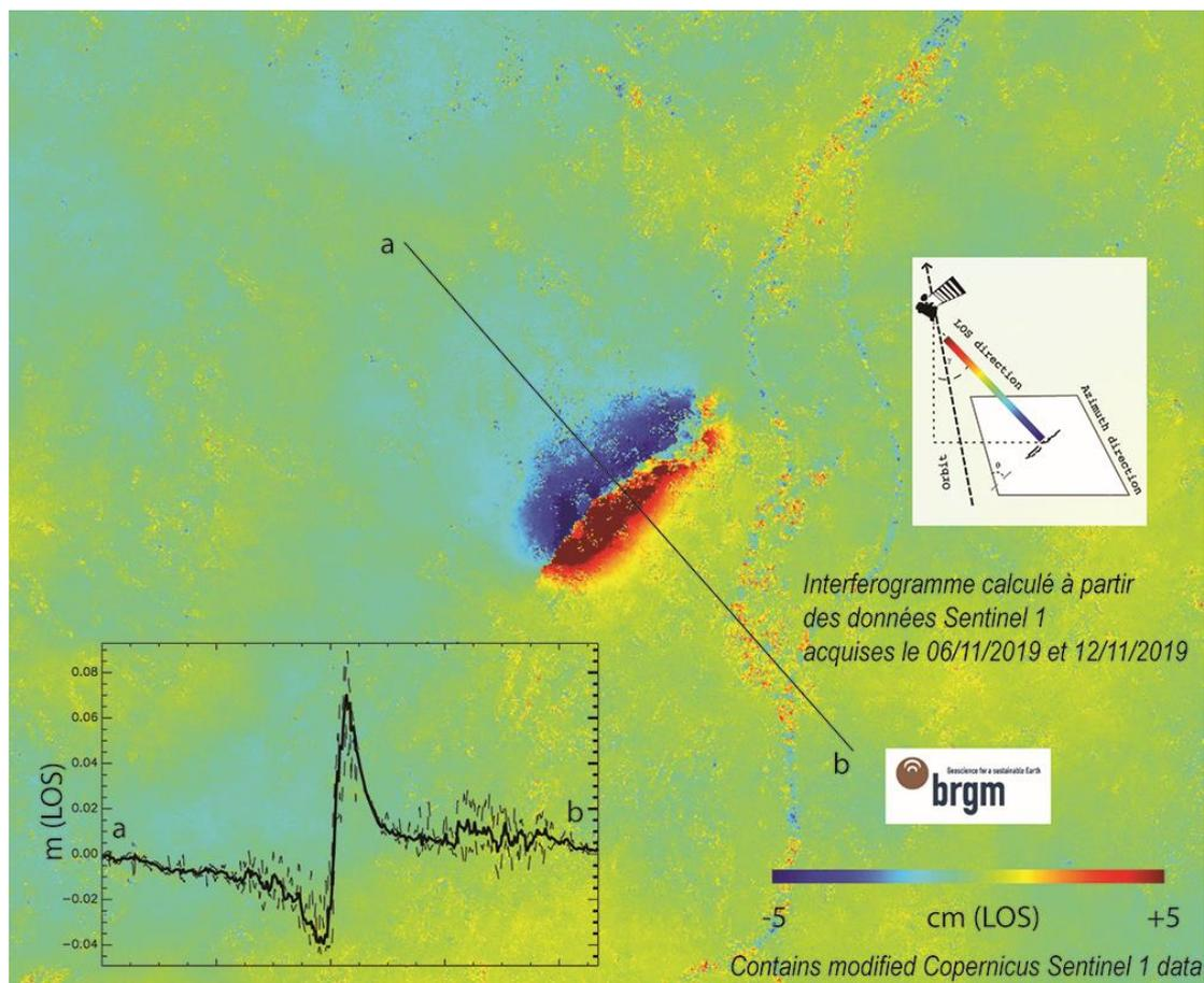
**Interferogramme calculé à partir des données Sentinel 1 (programme EU COPERNICUS) acquises le 06/11/2019 et 12/11/2019, orbite ascendante. Les franges interférométriques sont déroulées. Mesure du champ de déplacement en ligne de visée (LOS – Line of Sight). Des valeurs de LOS > 0 ici signifient que le sol a bougé vers le satellite. Calculs effectués au BRGM avec l’outil GAMMA, par Michalis Fouvelis et Marcello de Michele @BRGM. Contains modified Copernicus Sentinel 1 data.**
